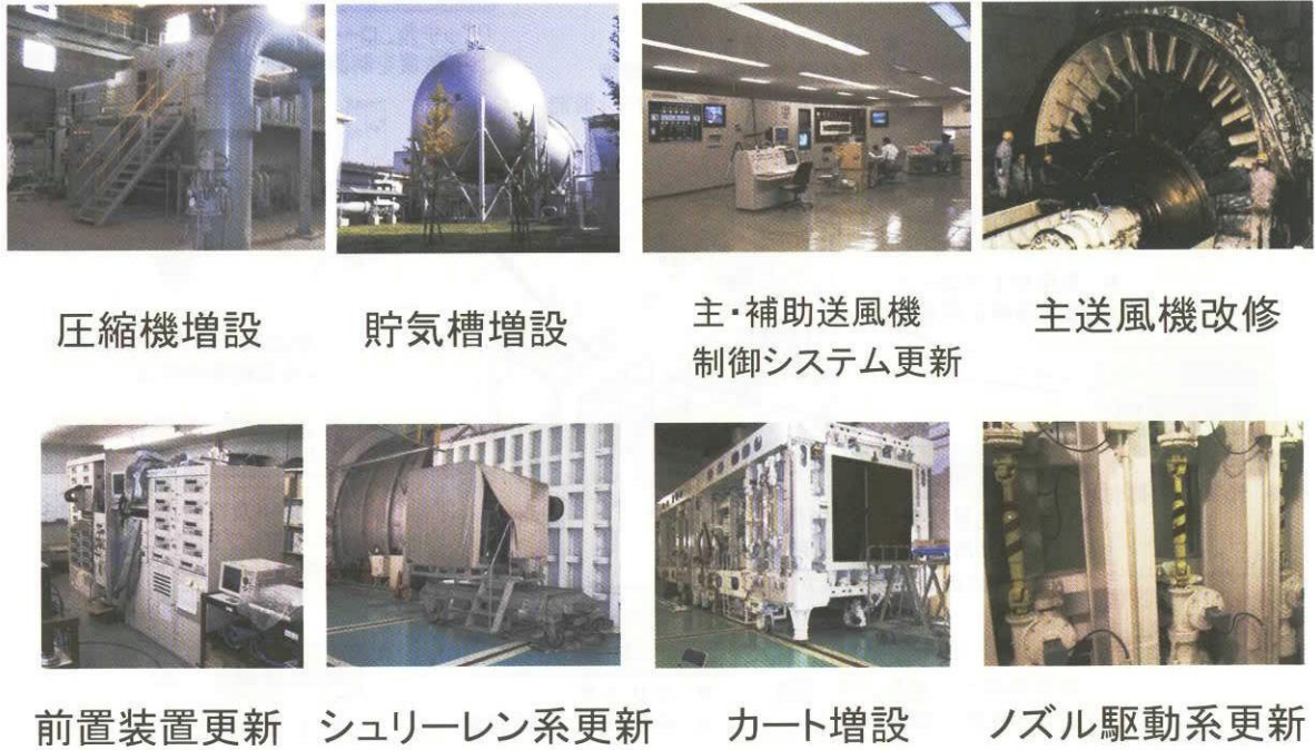
図3 (b). 遷音速風洞改修部分 (個別)
