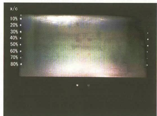
図 2: 感温液晶による表面温度可視化結果例 M_\infty=0.69 , p_0=200 kPa
