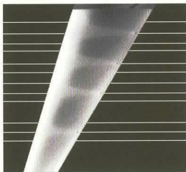
図 10: 表面温度上昇量分布 ( M_\infty=0.7, p_0=60 \text{ kPa}, \alpha=3.5^\circ )
