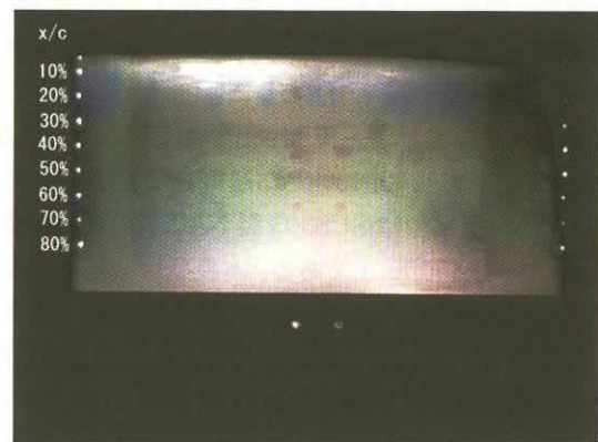
図 2: 感温液晶による表面温度可視化結果例 M_\infty=0.69, p_0=200 \text{ kPa}
