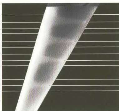
図10: 表面温度上昇量分布 ( M_\infty=0.7, p_0=60 \text{ kPa}, \alpha=3.5^\circ )
