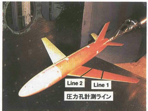
Fig.4-1 PSP/TSP 塗装された ONERA M5 模型と圧力孔列の設置位置 右舷側 (ピンク) : PSP、左舷側 (黄色) : TSP
