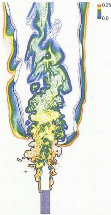
図6: 酸素分子拡散層と島状拡散火炎 色付き等値線は酸素質量分率、黒線は当量比1の等値線、灰色に塗られた部分は水素消費速度 5000 \text{ mol/m}^3/\text{sec} 以上の部分を表す
