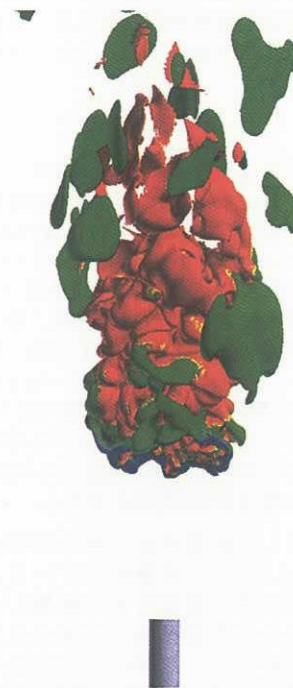
図 5: 浮き上がり火炎の全体構造 等値面は水素消費速度 10^4 \text{ mol/m}^3/\text{sec} の等値面であり、表面の色は燃焼モード、赤: 過濃予混合火炎、青: 希薄予混合火炎、緑: 拡散火炎を表している
