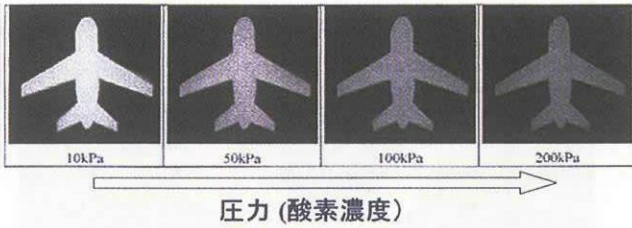
Fig.2-1 PSP 発光量と圧力の関係
