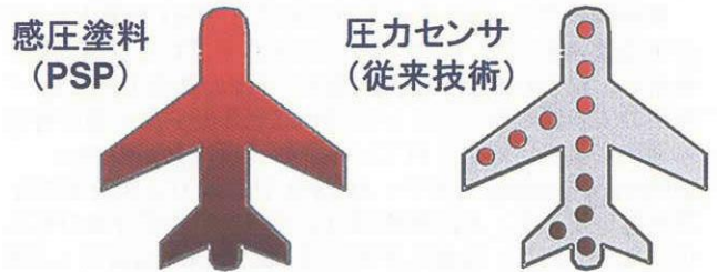
Fig.2-4 PSP と従来センサの計測領域イメージ
