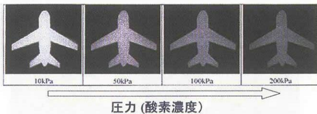
Fig.2-1 PSP 発光量と圧力の関係
