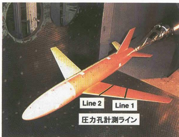
Fig.4-1 PSP/TSP 塗装された ONERA M5 模型と 圧力孔列の設置位置 右舷側 (ピンク) : PSP、左舷側 (黄色) : TSP
