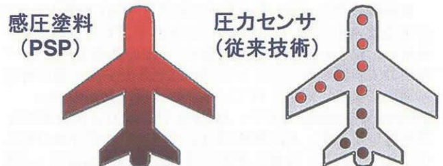
Fig.2-4 PSP と従来センサの計測領域イメージ
