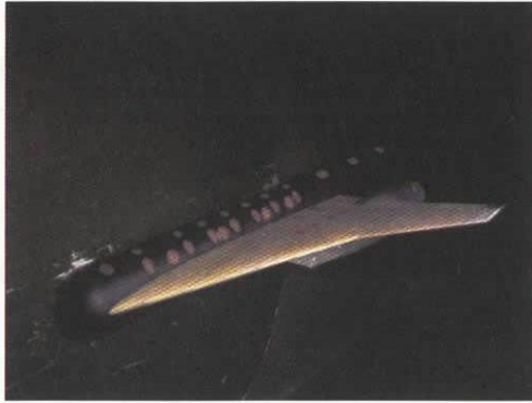
図 3 フラッタ風洞模型セットアップ
