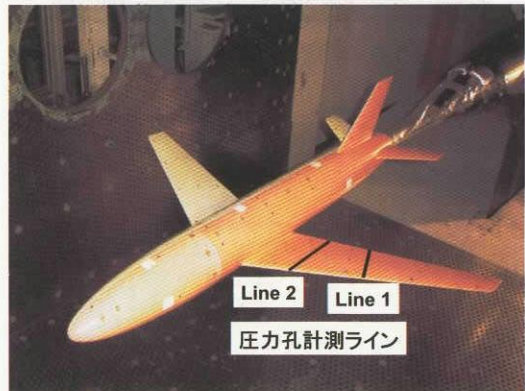
Fig.5 PSP/TSP 塗装された ONERA M5 模型と圧力孔列の設置位置
