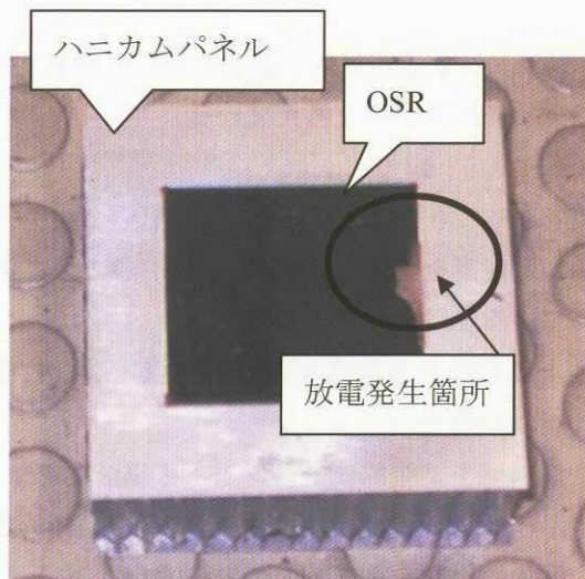
図 2.6-1 OSR 表面の損傷例 (OSR 蒸着層が昇華し下面に塗られていた接着剤が見えている)
