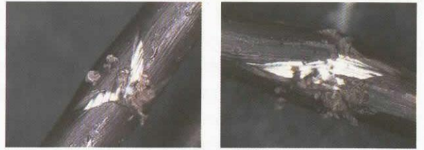
図 4 半田ごてによる被覆材加熱試験で発生したクラック
