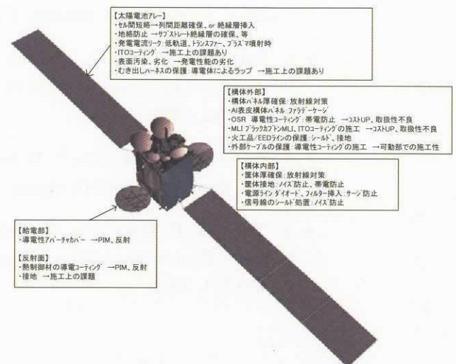
図 2.1-1 帯放電に関する衛星システムの一般的設計例及び課題
