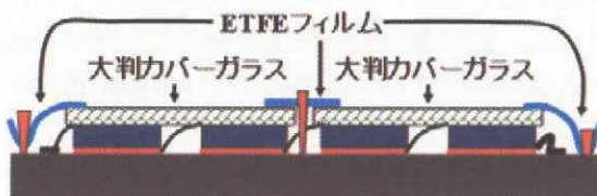
図6 継ぎ目付き大判カバーガラス クーポンの断面図
