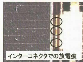
図19 インターコネクタでの典型的な放電痕
