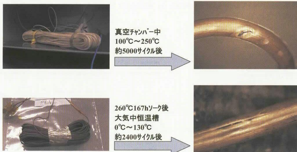
図13 ハーネス温度サイクル試験結果
