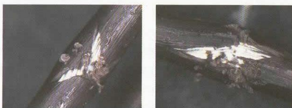
図 4 半田ごてによる被覆材加熱試験で発生したクラック
