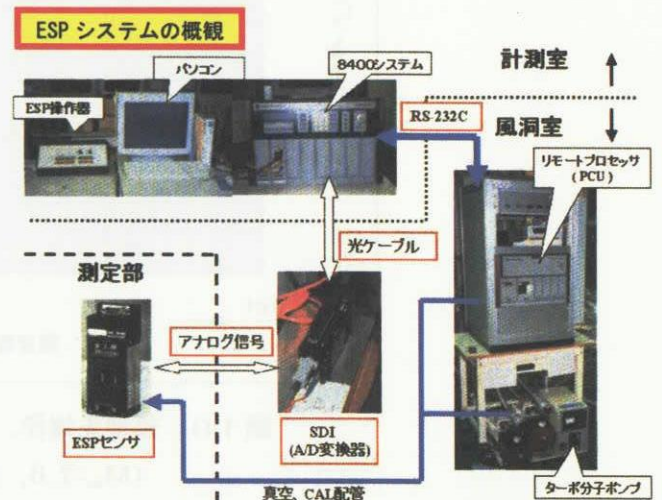
Fig. 1 極超音速風洞の ESP システム概観図
