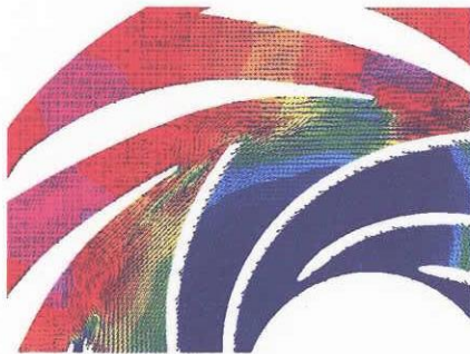
(1) ディフューザ入口近傍の瞬時の静圧分布
