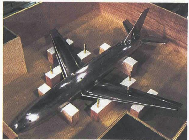
(b) 2m×2m 遷音速風洞用 M5 模型 (平均表面粗さ(Ra, 実測値): 0.07 μm[主流方向] 0.17 μm[主流垂直方向])
