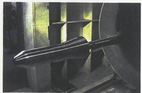
図5 1.27m 極超音速風洞/HIEST 共用 HB-2 空力加熱模型 (1.27m 極超音速風洞取付状態)
