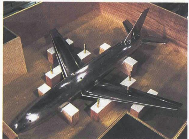
(b) 2m×2m 遷音速風洞用 M5 模型 (平均表面粗さ(Ra, 実測値): 0.07 \mu\text{m} [主流方向] 0.17 \mu\text{m} [主流垂直方向])
