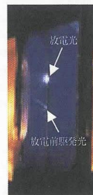
第3図 放電発生時の代表的な過渡電流波形と供試体写真 ( d=0.8\text{mm} , V_a=77\text{V} )
