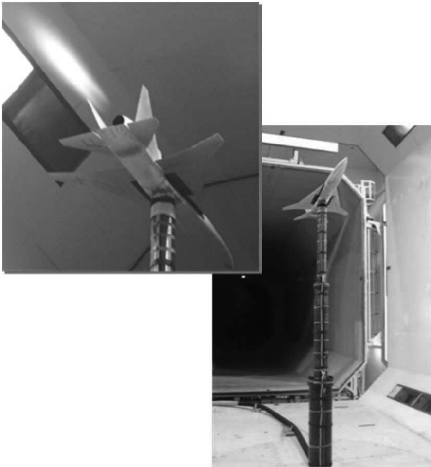
Fig.3.2 尾翼排気干渉風洞試験の様子[18]
