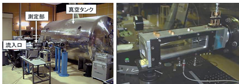
図2-1 (左) 東北大学吸込み式超音速風洞, (右) 測定部
