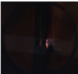
図 14 ワイヤーワイヤ/基板構成での 2.3 \times 10^{-4} Torr での放電の様子
