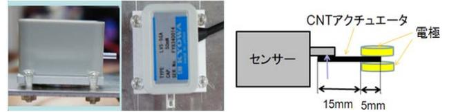
Fig.7 微小荷重測定センサーと発生力測定方法
