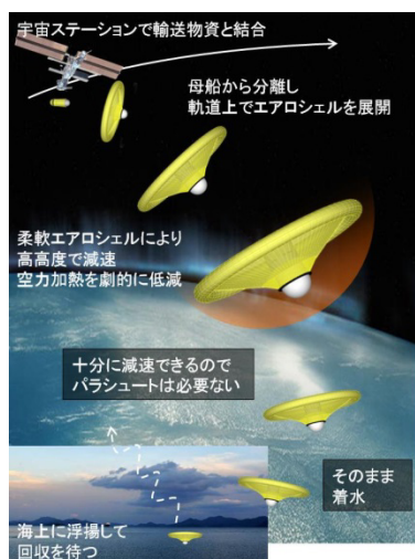
図 1 柔構造エアロシエルを用いた大気圏再突入の模式図
