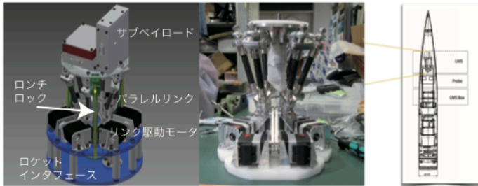
HEXA型パラレルリンク機構の打ち上げ状態(左がCG,中が試作機,右がS-310ロケットでの搭載位置)
