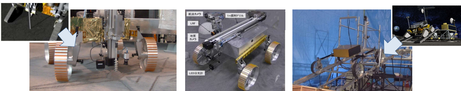
ドリル搭載ローバの試作例(左:掘削時、右:ドリル収納時) 全体構成・作業手順等を検証するための試作を実施中。
