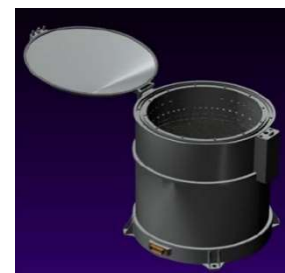
DESTINYダストアライザ (DDA) の概念図
