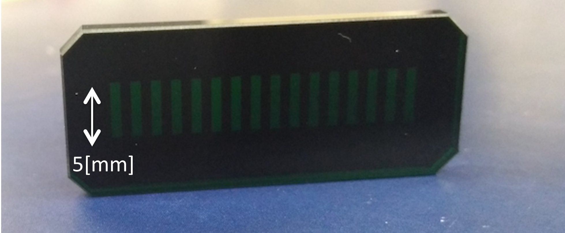
図3:測定に用いたレティクル試作品。
