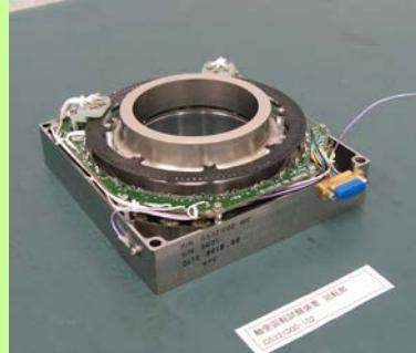
薄肉大口径(3インチ径)の玉軸受を使用し最大Φ68mm開口が可能。新規に設計した中空のDCブラシレスモータでロータ駆動。位置検出用にロータリ光学エンコーダ(黒色のディスク)を搭載。上端のリングはロータに取り付けた回転体ダミー。
