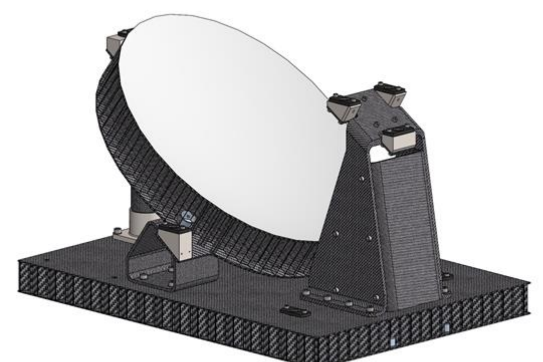
現在試作中の熱的寸法安定な テラヘルツ鏡面支持構造
