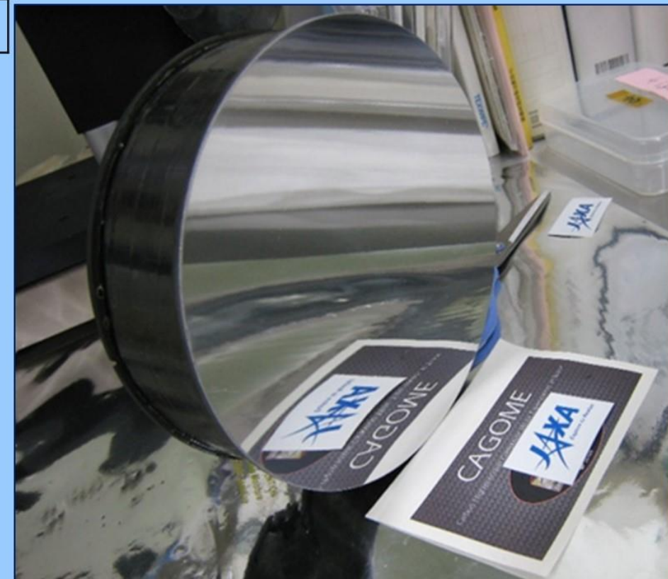
CS鏡面を持つ 高精度CFRP鏡 (2016年度製作)
