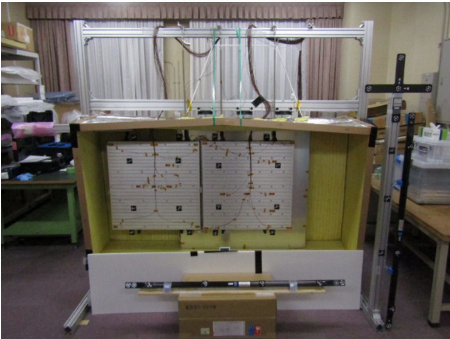
図3. 小型SARアンテナEMパネル熱変形試験 パネル2枚+ヒンジ
