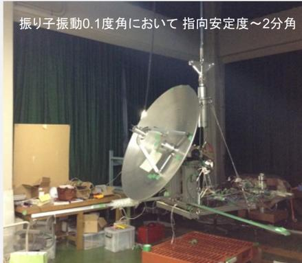
ゴンドラシステムの製造と吊り試験
