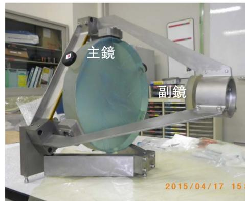
熱ひずみ検証モデル 外観
