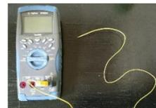
熱電対を計測する地表面に差し込み温度を計測
