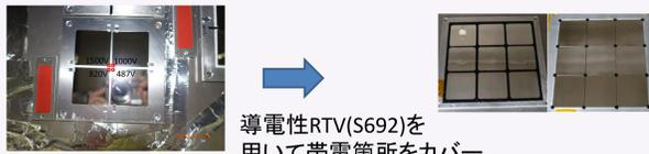
導電性RTV(S692)を用いて帯電箇所をカバー
