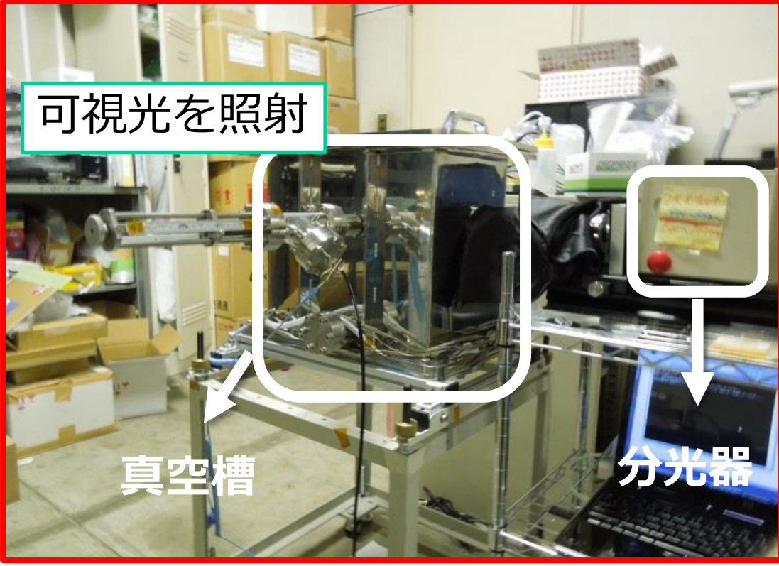
Fig.3 FM1の可視光の透過率の測定を行った。 真空槽内のCBFを透過し400~990 nmの可視光をフォトダイオードに照射した。
