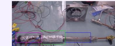
加熱部 ヒータ取り 断熱部 フレキシ部分 冷却部、ファンで強制空冷り付け
