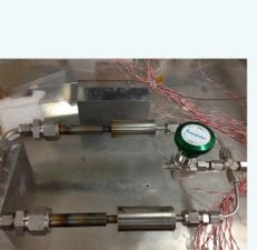
マルチエバポレータを有したLoop Heat Pipe
